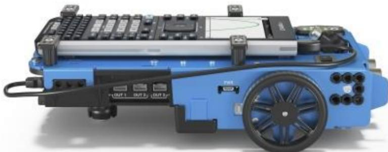
**Nota:** Con l'hub inserito, accedere tre porte per controllare i moduli di output.
