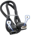
A black USB cable with a Mini-A connector on one end and a Mini-B connector on the other.                   | Incluso nel Hub.<br>Collega il Hub a una calcolatrice grafica TI CE o a un palmare TI-Nspire™ CX.       |
