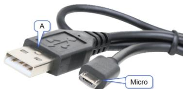
2. Inserire il connettore Micro nella porta **PWR** sul lato del Rover.
