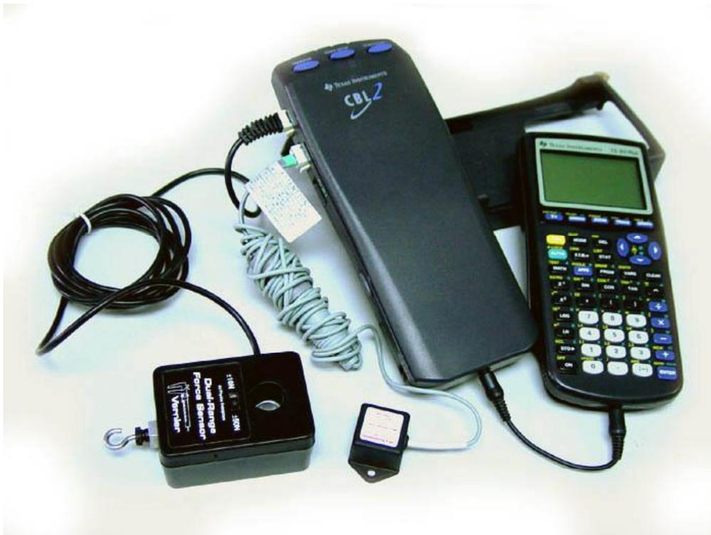
所有的 TI 实验设备按照图片的方式连接，为了能统一，将力传感器插入 CBL2 左侧的 CH1 中，加速度传感器插入 CBL2 左侧的 CH2 中。CBL2 和 TI 计算器之间用 unit-to-unit 连接线连接。
