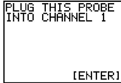
进入 CALIBRATION 界面，三个项目中，按上、下光标键，选择 1: USE STORED，使用预设的传感器斜率和截距参数设置。如果选 3，可以选择其他的传感器，不过你需要手动输入斜率和截距参数。
