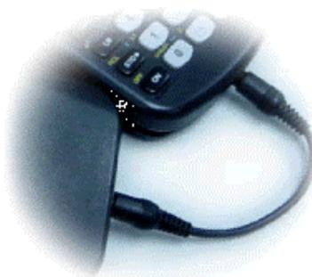
CBL2 有三个 CH 通道，一般是都是从 CH1 开始依次插入传感器，而传感器种类和插入的顺序无关。注意传感器的接口是和网络连接线类似的接口，有挡舌的一端在下，不会插反。插到底挡舌会自动锁住。要拔出传感器的时候按住挡舌后可以拔出了。
